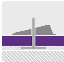
Evita el desnivel durante el proceso de fraguado del adhesivo
