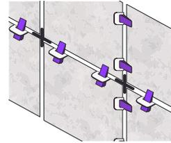
En paredes/muros se recomienda el uso de Espaciadores de Cerámicos para evitar que el Espaciador Autonivelante quede trabado por el peso del revestimiento.
